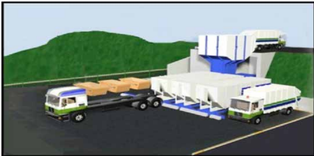
Figura 12. Ejemplo de un centro de transferencia.
