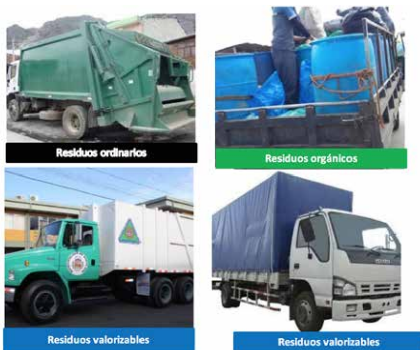
Figura 10. Ejemplo de tipos de camiones para la recolección y recuperación de residuos
